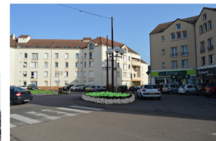
La place présente beaucoup de surfaces imperméables. Le peu de surfaces perméables sont en hauteur par rapport à la voirie et ne récupèrent pas les eaux de pluies
